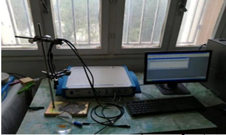
الشكل (10) : جهاز الجهد الكهربائي Voltalab.PGN 201.Potentiostat-Galvanostat
